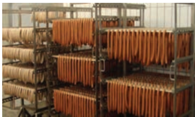
شکل ۱۳- پخت در اتاق پخت با بخار
