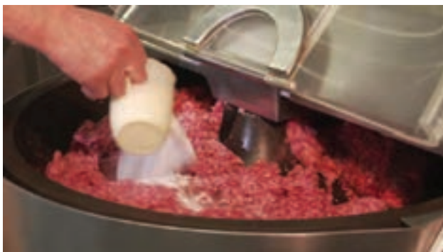
شکل ۷- مخلوط کردن مواد در دستگاه کاتر
